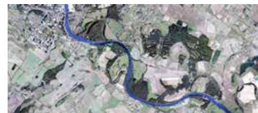
Labe v polovině 19. století a dnes. Na obrázcích je patrné narovnění a zkrácení toku.
